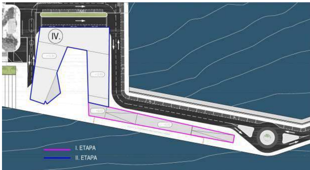
Slika 16: Etapnost izgradnje lučke nadgradnje
